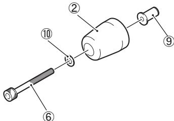
6. Den Vorderachsschieber (L) ② am Motorrad montieren.
