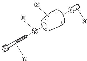
6. Instale el deslizador del eje delantero (Izq.) ② en la motocicleta.
